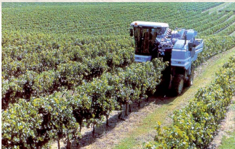
Vendemmiatrice in azione in terreno inerbito. L'inerbimento consente l'impiego di mezzi pesanti come le vendemmiatrici.
